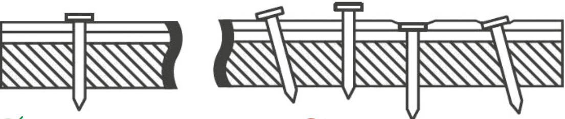
Рис. 3. Пример правильной забивки гвоздей при монтаже продукции.
