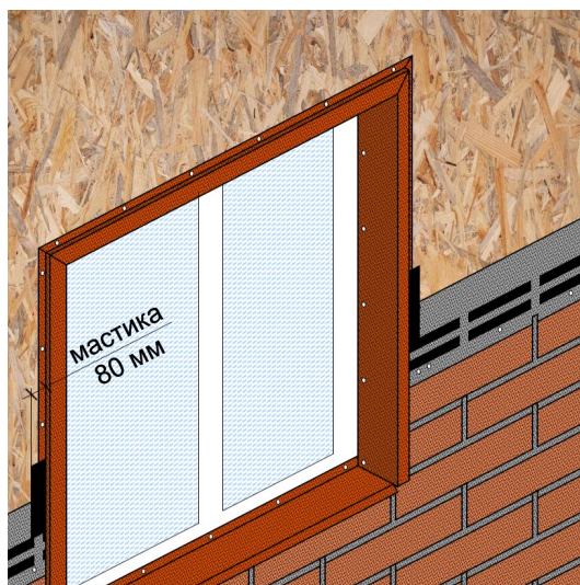
Рис. 32. Монтаж фасадной плитки вокруг оконного проёма на наличник 3D с посыпкой (тип 5, таблица №2).
